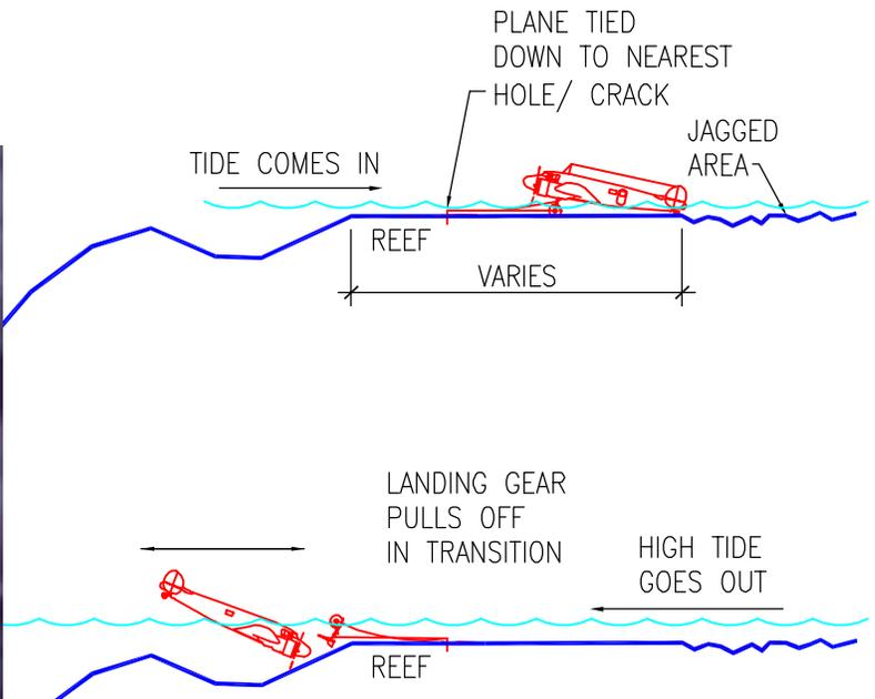
PLANE FLOATS OFF. GETS STUCK IN HOLE WAVES BRAKE PARTS OFF
